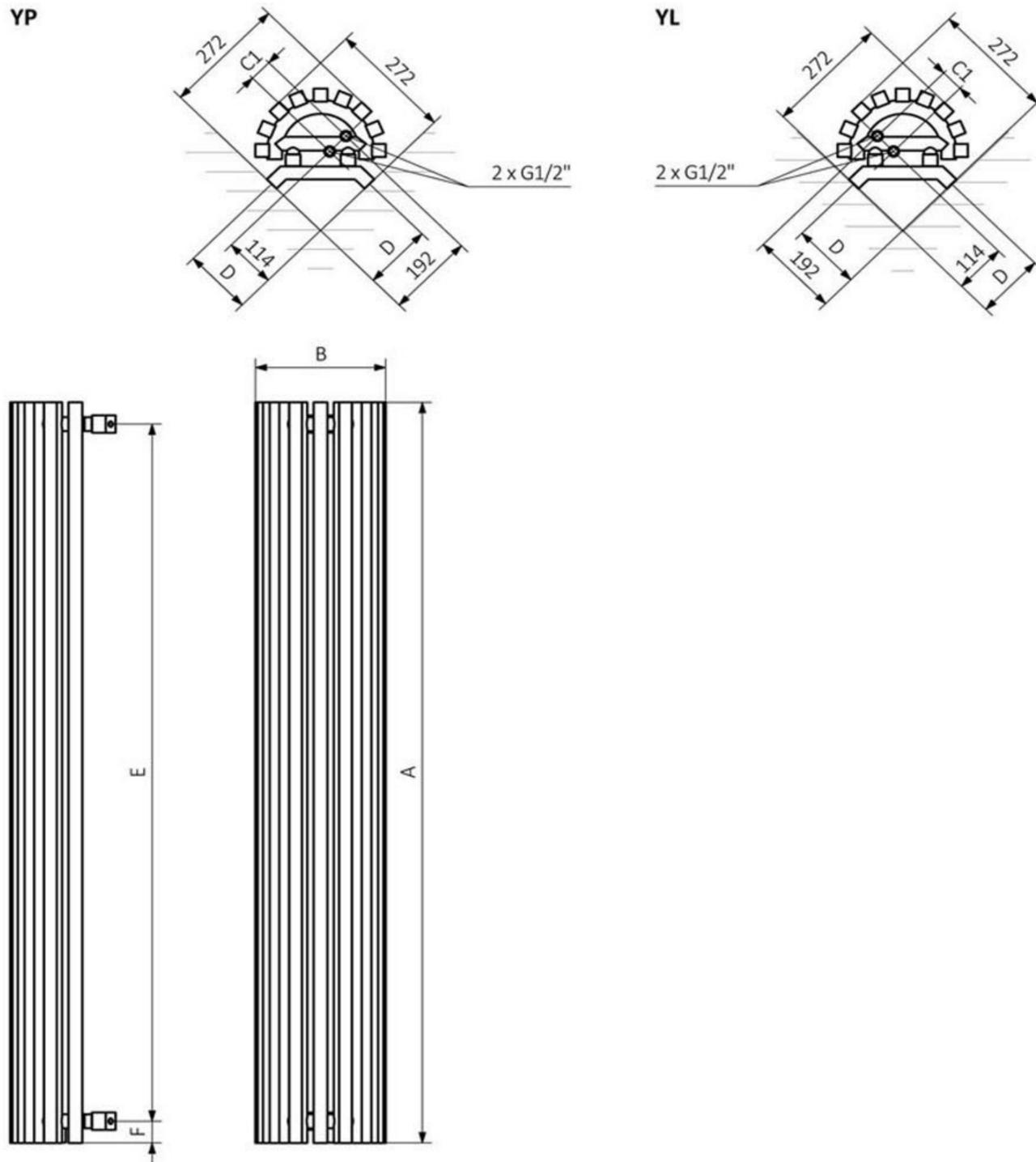
A - Höhe B - Breite C1-C5 - Anschlussabstand D - horizontaler Wandhalterungsabstand E - Vertikaler Wandhalterungsabstand F - Abstand von der Achse der unteren Wandhalterung bis Unterkante des Kollektors
